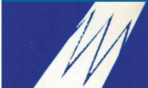
LA CINGHIA DENTATA VIENE CHIUSA AD ANELLO PER MEZZO DI UNA PRESSA TRASPORTABILE. LA PRESSA VIENE PORTATA A TEMPERATURE CON DELLE RESISTENZE INTERNE ED È DISPONIBILE SIA NELLA VERSIONE STANDARD CHE CON RAFFREDDAMENTO AD ACQUA.
