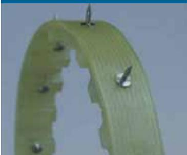
Le cinghie dentate con chiodi rivettati in acciaio inox inseriti nel dente sono ideali per il trasporto del pesce. Le dimensioni standard sono 6 T10 600 e 10 T10 600 cavi in fibra di vetro e chiodi ogni due denti. I chiodi possono essere fissati anche a passi diversi su richiesta del cliente.
