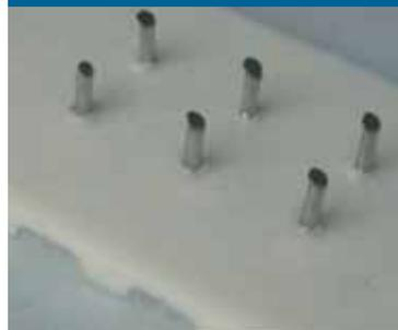
La cinghia con aculei è usata nel settore del trasporto del pesce. La larghezza degli aculei è 10 mm con uno spessore di 1,4 mm.
